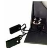
Unidad reguladora de la intensidad luminosa
