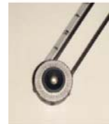
Orificio para el control de la alineación de la pupila y punto de fijación
